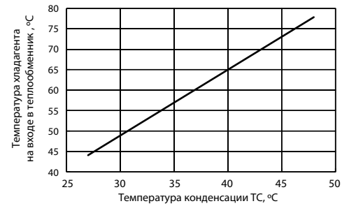
Рис. 2. Температура хладагента на входе в теплообменник
